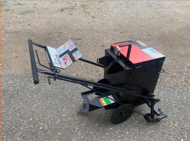
La macchina su ruote ideale per i piccoli lavori. Pronta per l'applicazione del sigillante in soli 20 minuti, e per un'efficace sigillatura di crepe e giunti è facile da usare e **completa di miscelatore manuale** per favorire la velocità di fusione e l'uniformità del mastice prima dell'uso. Completamente controllata dall'operatore dalla barra di spinta, adotta un potente **impianto di riscaldamento a gas con bruciatore manuale**.
